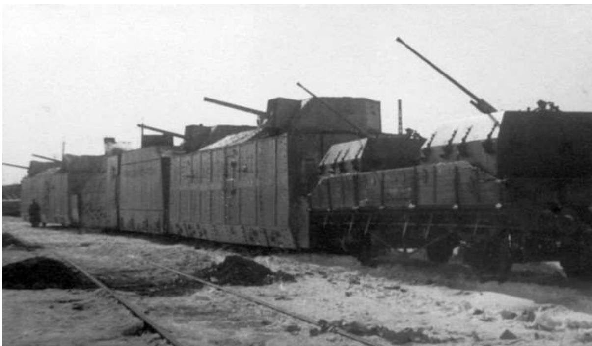
Весной 1942-го началась разработка БП-43. Этот лёгкий бронепоезд состоял из четырёх вагонов ПЛ-43, каждый из которых нёс башню Т-34. Сверх того, каждый поезд имел два ПВО-4-вагона, имеющего два 37-мм зенитных орудия для противодействия вражеской авиации. С позднего 1942-го до 1944-го был создан 21 бронепоезд.
